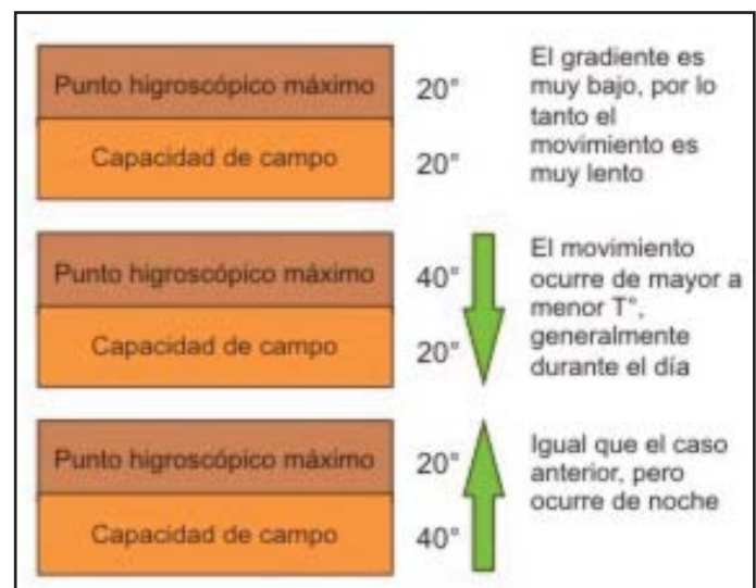
Figura 20: Movimiento del agua en la fase de vapor según la temperatura de las distintas capas de suelo.
