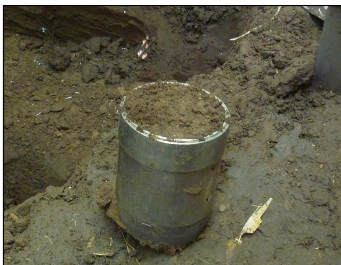
**Figura 5:** Cilindro, sombrero (parte de arriba donde se golpea) y filo (parte de abajo) con la muestra recién obtenida.
