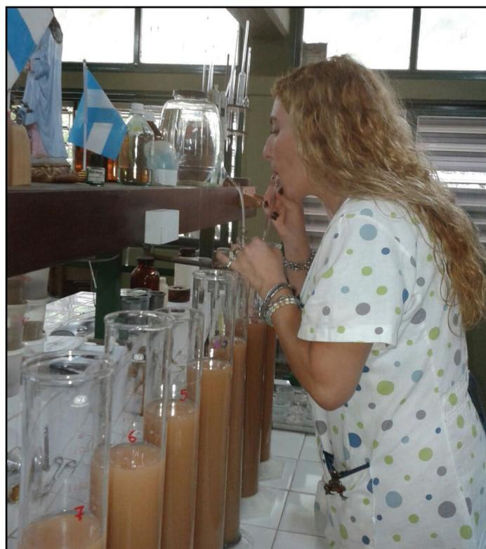
**Figura 2:** Método de la pipeta. Extracción de partículas a distinta profundidad.
